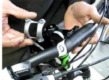
Slika 1/1: Montaža prednjega krmila
